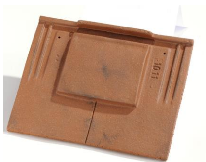
Tuile néoplate à emboîtement, rectangulaire, Petit moule : dimensions courantes 27/35cm, 20 tuiles/m²
