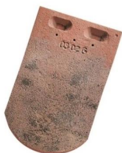
Tuile plate traditionnelle, écaille Petit moule : dimensions courantes 17/27 cm, 60 tuiles/m²
