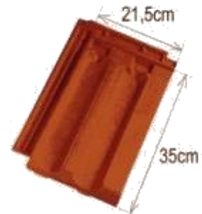
Tuile mécanique traditionnelle, à côte. dimensions courantes 21,5/35cm 13 à 20 tuiles/m 2
