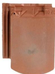
Tuile plate à emboîtement, écaille Petit moule : dimensions courantes 23,5/32cm, 22 tuiles/m²
