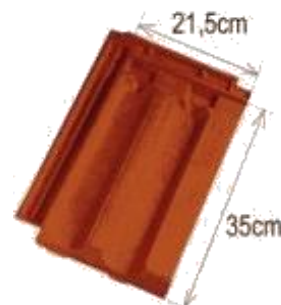
Tuile mécanique traditionnelle, à côte. dimensions courantes 21,5/35cm 13 à 20 tuiles/m²
