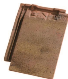
Tuile plate à emboîtement, rectangulaire Petit moule : dimensions courantes 23,5/32cm, 22 tuiles/m²
