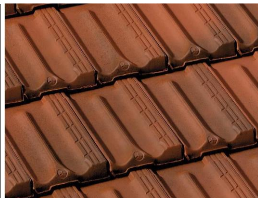
Tuile mécanique traditionnelle, à côte, (13 à 20 tuiles/m²). Dimensions courantes 21,5/35cm
